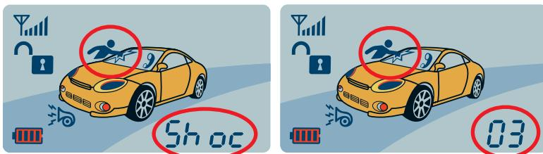
Если в режиме охраны система срабатывала только от датчика вызова владельца, то при снятии с охраны система сообщит об этом миганием
