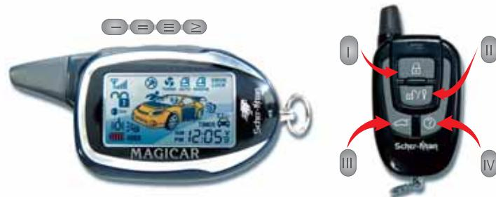
Если двери автомобиля открыты, то запирания не произойдет. Включение данной функции индицируется на дисплее брелока символом **DRIVE LOCK**.
