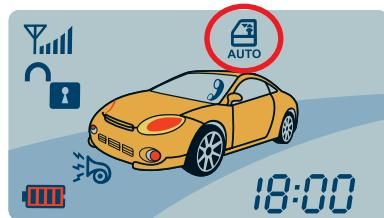
Смена режимов работы происходит длительным 2 сек. нажатием кнопок II+III брелока-коммуникатора в следующем порядке: (Функция включена, режим 1) > (Функция включена режим 2) > (Функция выключена) > (Функция включена, режим 1) и т. д.
