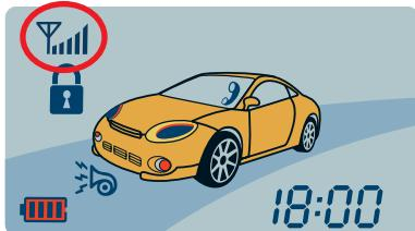
Показания индикатора изменяются только при получении сигнала обратной связи. Проверить наличие и качество связи между процессорным блоком и брелоком можно нажатием кнопки IV брелока-коммуникатора.
