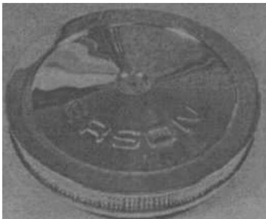
*Для большинства 4-камерных карбюраторов существуют специальные воздушные фильтры. Некоторые из них имеют небольшую высоту, чтобы иметь возможность без проблем установить такой фильтр под капотом.*
