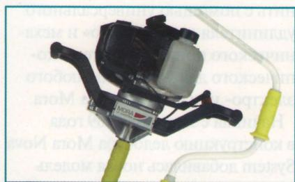
высоту выдвижения рукоятки ледобура. Затем нужно вытащить складную рукоятку, освободив отверстие шнека. В освободившееся отверстие вставьте вал двигателя и закрепите его моторным болтом M8, входящим в комплект двигателя. На рукоятке ледобура есть два разных крепежных отверстия со схематичными рисунками подсказок у каждого из них, так что крепле-
