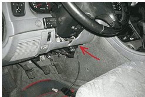
**Тип разъема №2 - 12-ти контактный прямоугольный и 16-ти контактный трапециевидный разъемы**
